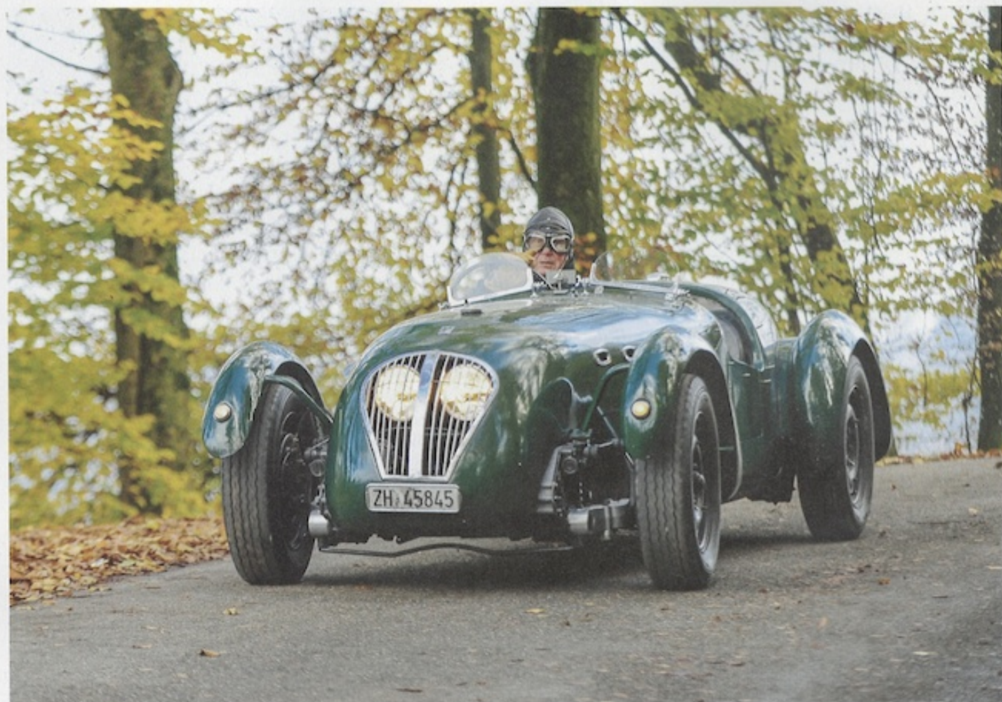
Das Healey-Chassis war ein selbst entwickelter Kastenrahmen aus 1,2 mm Stahlblech mit Querstreben. Auch die Vorderachse mit Schwingarm-Einzelradaufhängung und zwei Kurbellängslenkern sowie Kurvenstabilisator stammte aus dem Hause Healey. Ein Stabilisator verbesserte die Strassenlage. Die direkte und präzise Lenkung ist eine patentierte Healey-Konstruktion. Sie beruht auf dem Prinzip einer sich drehenden Platte und einem Lenkgestänge, welche die Kräfte vom Lenkgetriebe auf die Räder übertragen.
