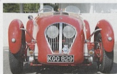
Der Type E war die zweite Ausführung des Silverstone-Fahrgestells und ab Mitte 1950 erhältlich. Diese Ausführung ermöglichte eine etwas breitere Carrosserie und mehr Beinfreiheit. Zudem besass der E eine grössere Windschutzscheibe und eine Hutze auf der Motorhaube.
