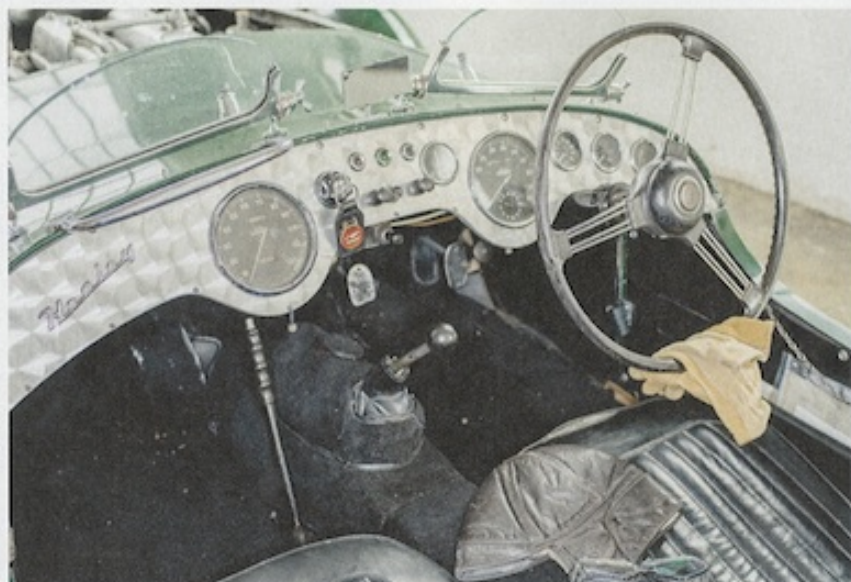
Die Instrumentierung zeigte, was der Fahrer wissen musste: Tourenzahl, Tempo, Ampèreleistung, Öldruck, Wassertemperatur und Füllstand des 16-Gallonen-Bezintanks.
