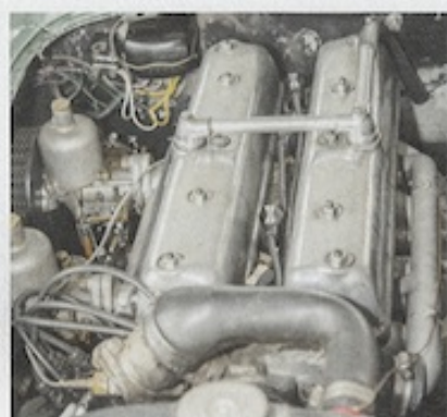
Der solide Vierzylindermotor mit OHV-Technik aus dem Hause Riley. Donald Healey hätte gern den Motor des BMW 328 verwendet. Der gute Kontakt mit Victor Riley und die Chance, sich auch mit Getriebe und Achse von Riley einzudecken, brachten ihn davon ab.
