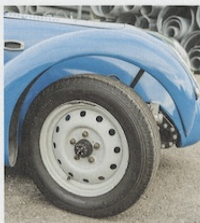
Die freistehenden, wuchtigen Kotflügel konnten für den Renneinsatz rasch demontiert werden.
