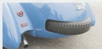
Der Querschlit am Heck nimmt das Reserverad auf. Der Überhang dient als Stossstange.
